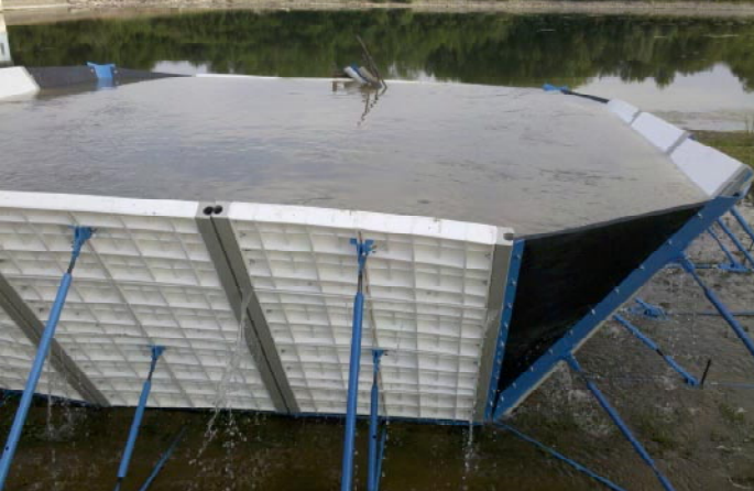
Bazénová skúška na overenie plnej výšky zábran zaťažených hydrostatickým zaťažením
